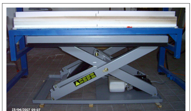
Abbildung 8: Boden mit hydraulische Hebebühne
